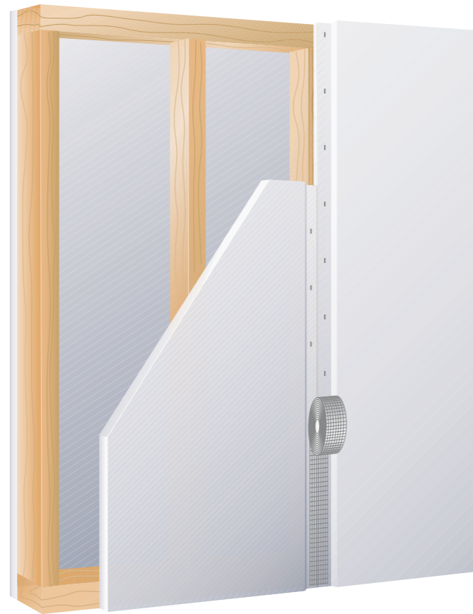
Tafla ścienna z drewnianych słupków, oczepów i podwalin z opłytywaniem płytami Rigidur H z obniżoną krawędzią (AK)
