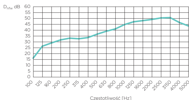
Izolacyjność akustyczna wzdłużna D_{nfw}
