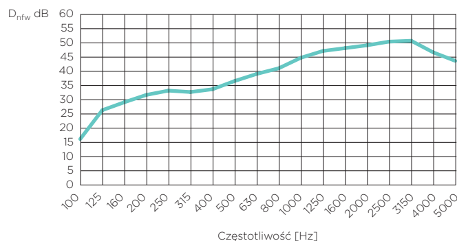
Izolacyjność akustyczna wzdłużna D_{nfw}
