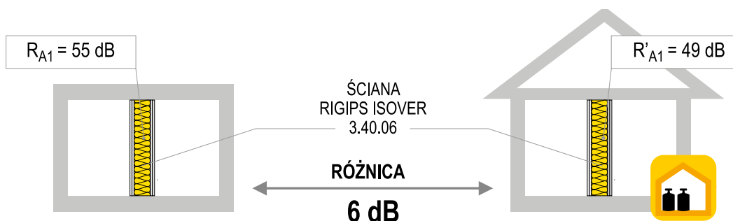
Rysunek 2. Przykładowa różnica pomiędzy laboratoryjnie zmierzonym wskaźnikiem R_{A1} a oszacowanym wskaźnikiem R'_{A1} (dla budynku „średniego”)
