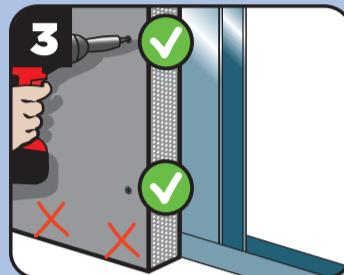
(FR) Joints de fractionnement (EN) Expansion joints (DE) Bewegungsfuge (ES) Juntas de expansión (IT) Giunti di dilatazione
