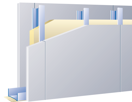
② Konstrukcja ściany nienośnej z konstrukcją metalową i opłytywaniem Rigidur H
